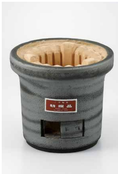
51SU 0006 木炭コンロ大型 銀 (300×270)1入 6,600 (中:珪藻土、外:三河土の二重構造)
